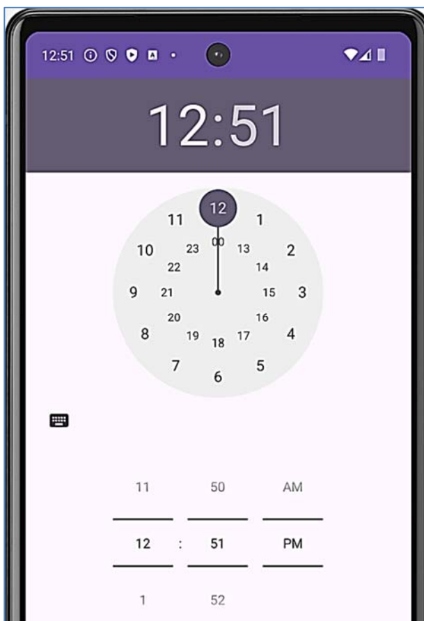
Rysunek 6.132 TimePicker – wersja w postaci zegara (na górze), oraz wersja w postaci Spinnera (na dole)
