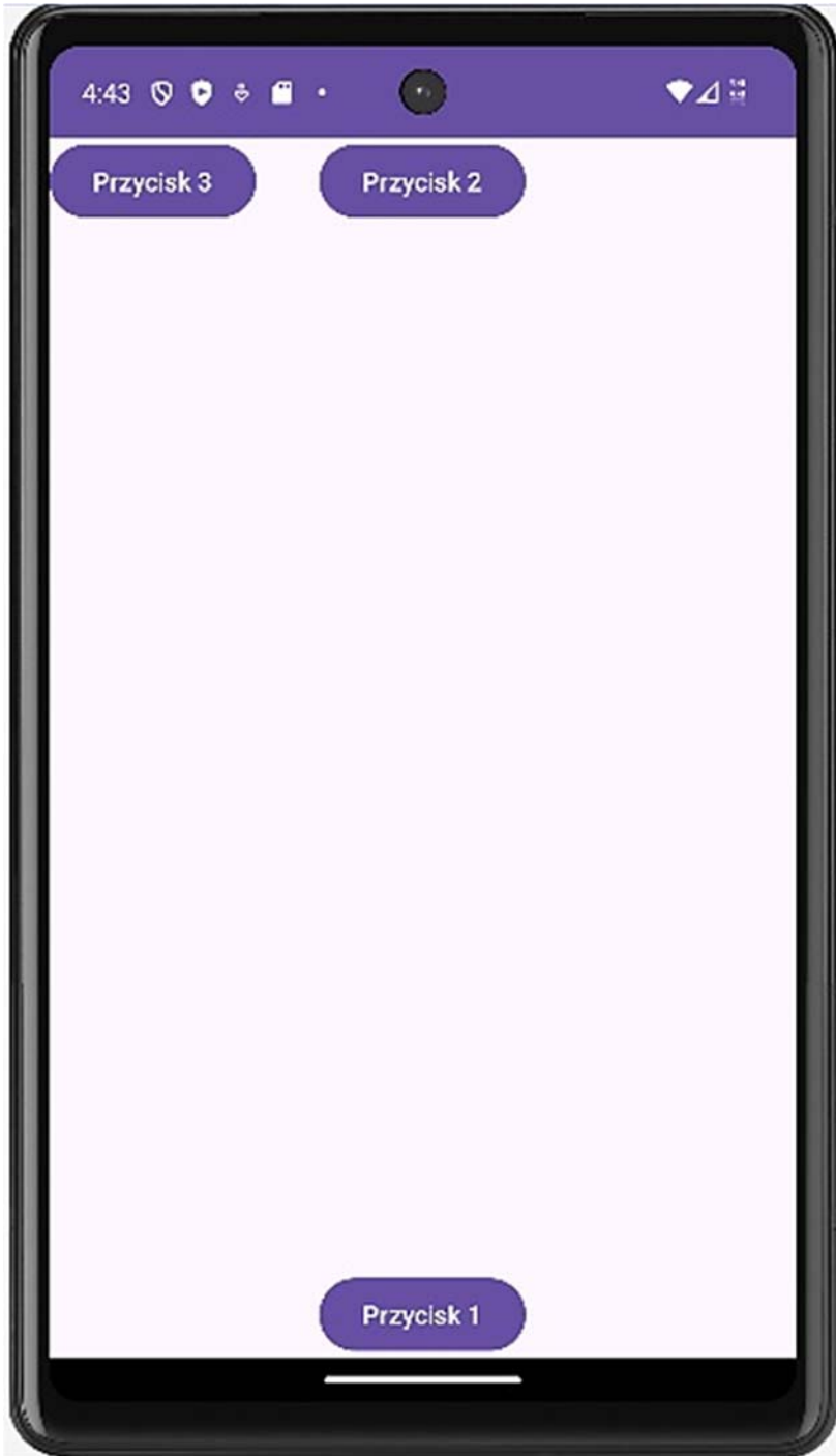
Rysunek 6.64: Ułożenie przycisków po zastosowaniu układu RelativeLayout
